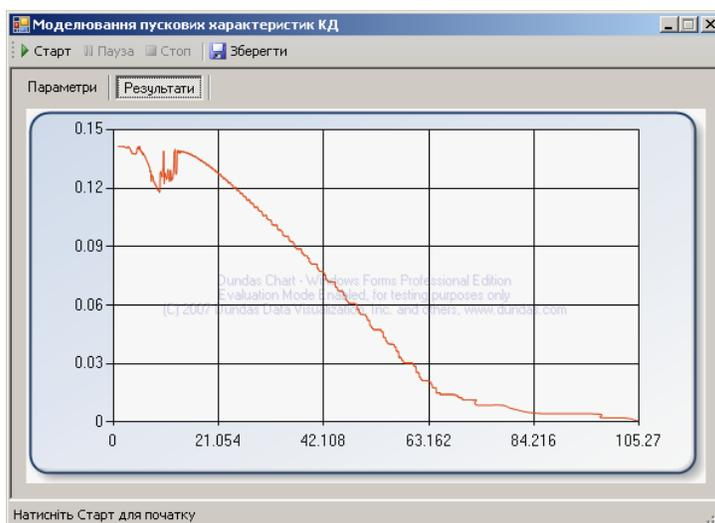
Рис. 6. Результаты моделирования пусковой характеристики ШД M35SP-6
