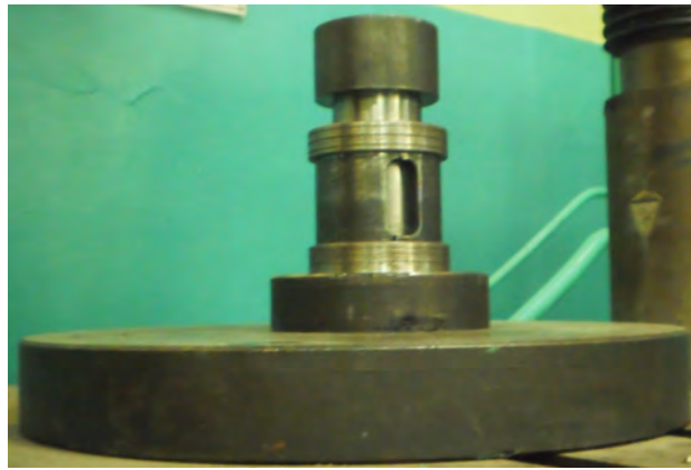
Рис. 6. Приспособление для осесимметричной осадки на гидравлическом прессе ПММ-125
