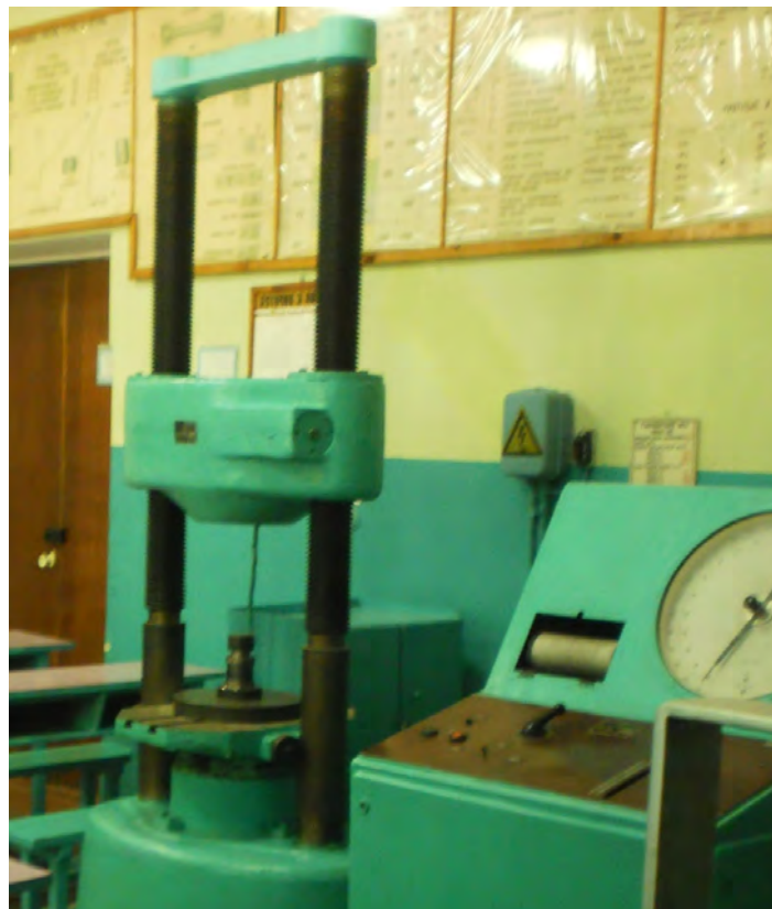
Рис. 5. Общий вид гидравлического прессы ПММ-125
