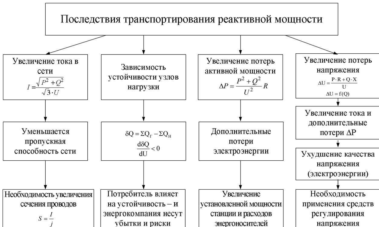
Рис. 1. Факторы влияния реактивной мощности на электрическую сеть
