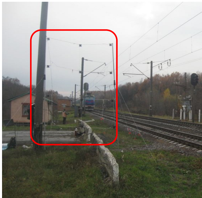
Рис. 1. Место размещения экспериментальной измерительной установки (рамка сенсоров обведена красной линией)
