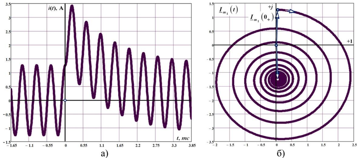
Рис. 2. Переходная волновая диаграмма мгновенного тока  $i_1(t)$  и временной годограф мгновенного комплексного тока  $\underline{I}_{m_1}(t)$
