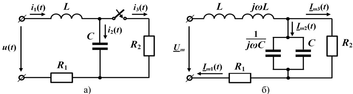
Рис. 1. Электрическая цепь 2-го порядка и её переходная комплексная схема
