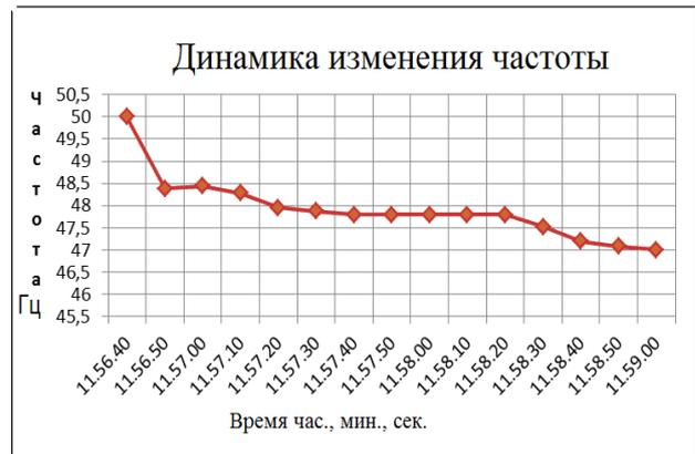
Рис. 3. Переходный процесс изменения частоты в системе ОЭ
