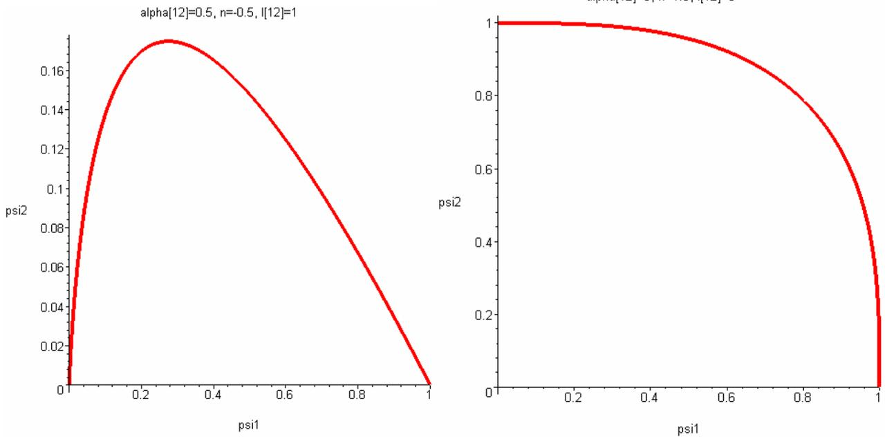
Рис. 1. Графики зависимостей между ресурсами пластичности при двухэтапной деформации, когда  $\alpha_{12} = 0,5$ ;  $n = -0,5$ ;  $I_{12} = 0,6$ ;  $I_{12} = 0,9$ ;  $I_{12} = 1$ ;  $I_{12} = 0$ .
