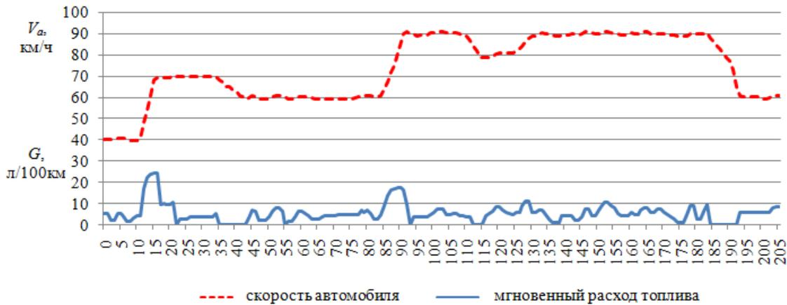
Рис. 5. Зависимость скорости автомобиля Volkswagen Passat B6 и расхода топлива от времени при движении по магистральному циклу на дороге
