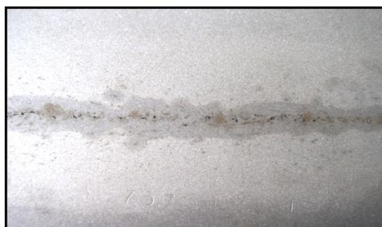
Рис. 1. Макроструктура продольного темплета непрерывнолитой заготовки из стали С80D (скорость вытяжки 3,4 м/мин; удельный расход воды в ЗВО 1,30 л/кг)
