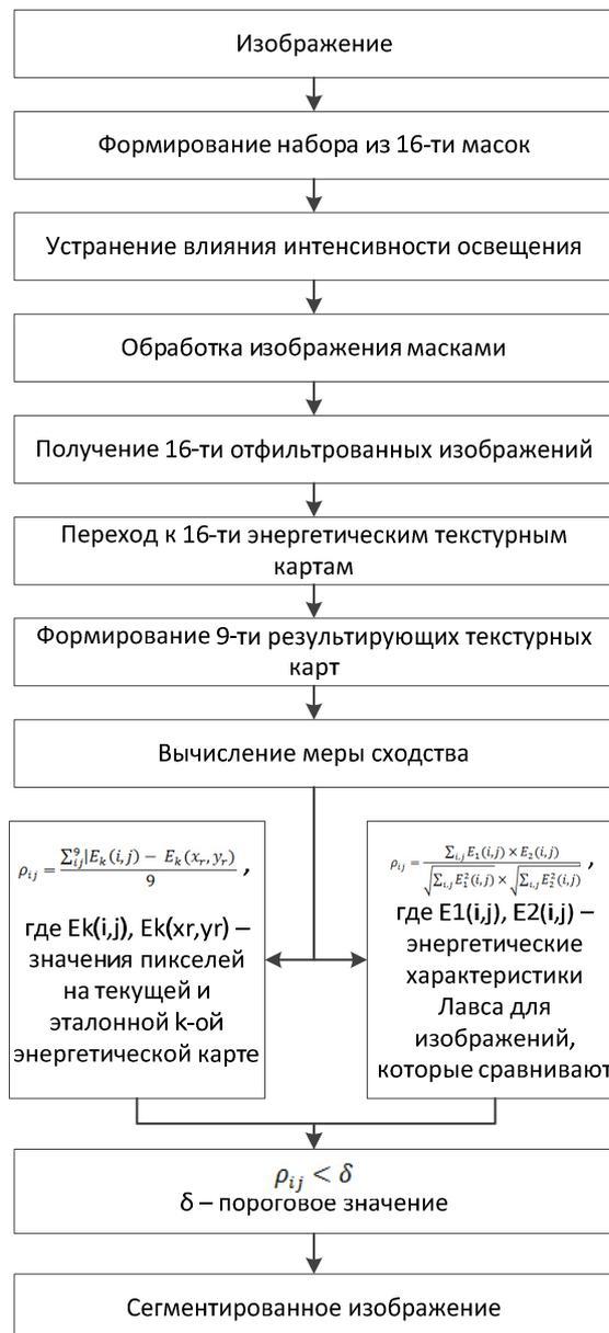
Рис. 1. Алгоритм сегментации с использованием энергетических характеристик Лавса
