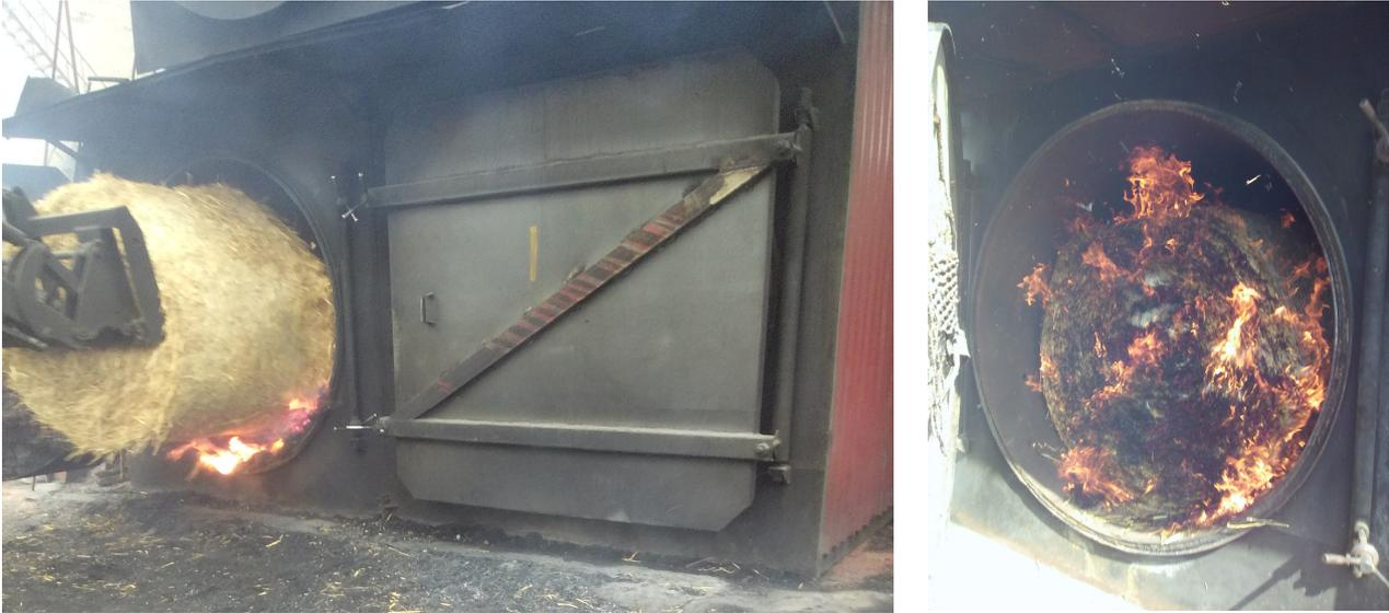
Рис. 2. Процесс загрузки тюка соломы в теплогенератор и горение
