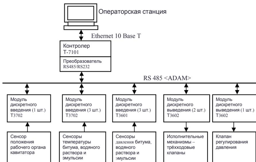
Рис.2. Структурная схема АСУТП приготовления битумной эмульсии
