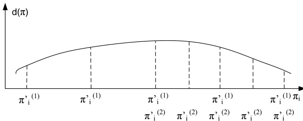
Рис. 2. Определение максимума функции методом дихотомии
